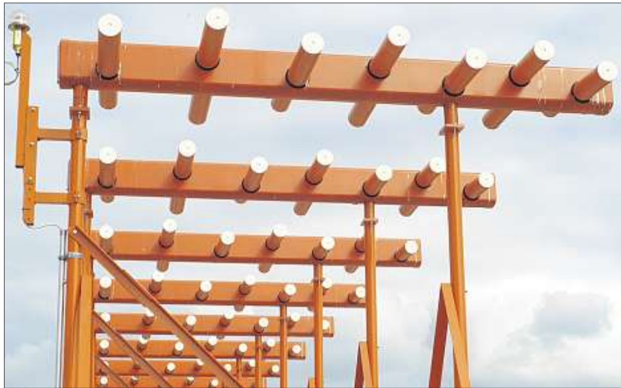
Der Localizer (Landekursender, hier der Piste 34): ein wichtiger Bestandteil des Instrumentenlandesystems. (Werner Loosli)
